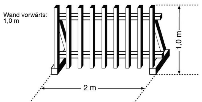
Eine auf die Fahrzeugmaße abgestimmte Einstellung erfolgt nicht. Die Abstandszone sollte durch eine am Gatter montierte Peilvorrichtung bzw. mit Kreide vor dem Gatter genau fixiert werden.
